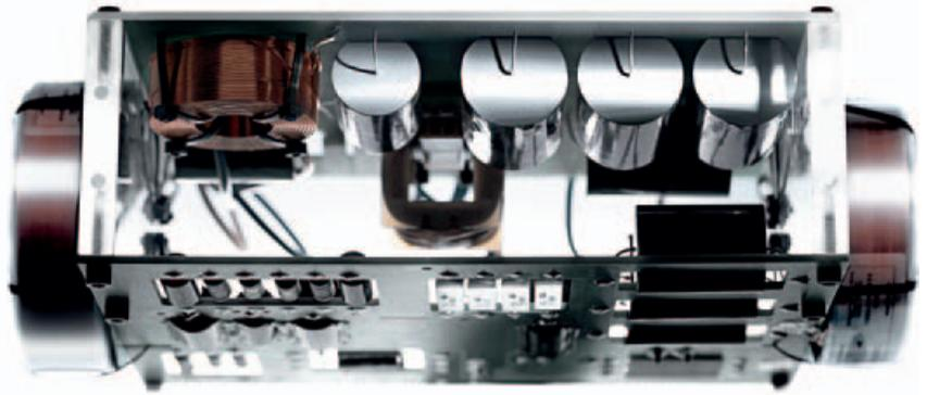
**ZUORDNUNG:** Die Frequenzweiche der Evidence Platinum gehört zu Dynaudios DDC-Technologie. Keramikwiderstände, Kupfer-Luftspulen und Solen-Kondensatoren sitzen auf glasfaserverstärkten Platinen mit grosszügigen Kupferleitbahnen. Die Weiche sitzt unter dem Mittel-Modul in einem eigenen Abteil.
